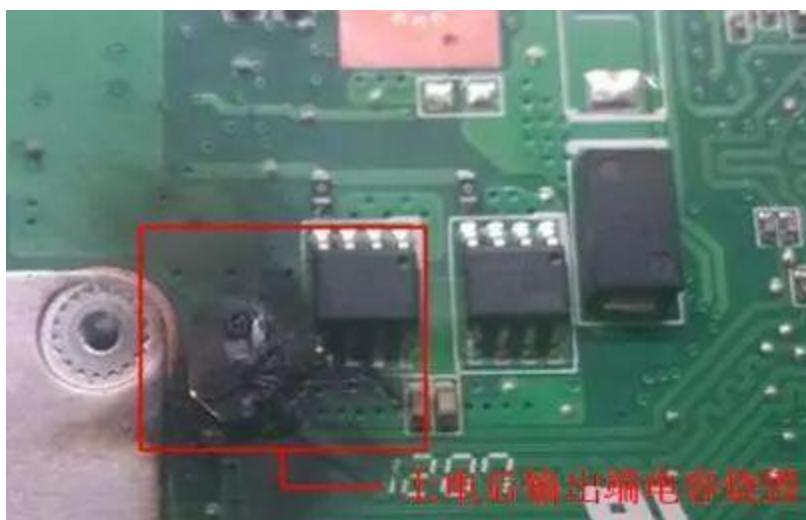
图 5 电源模块损坏
