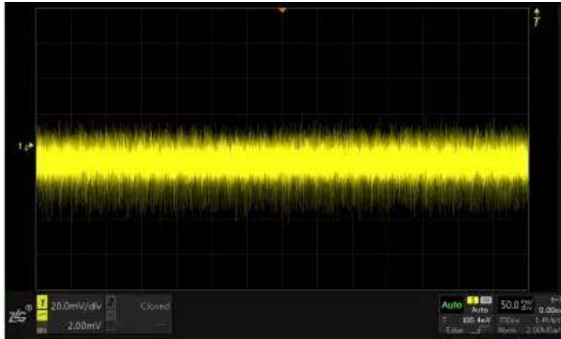
图 2 电源纹波波形图
