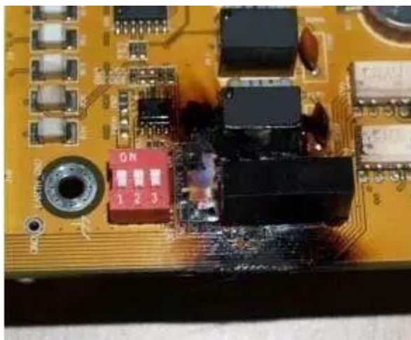
图 6 电源模块烧毁
